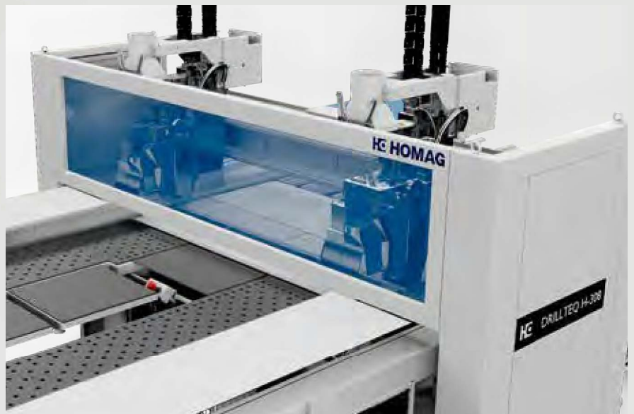
防护罩封闭加工区域, 确保加工过程中人员的安全 (避免人员接触加工机头和移动的部件)。
